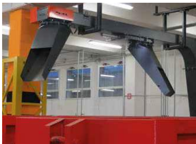
Trasportatore a palette con doppio scivolo di scarico su container Scraper conveyor with double discharge slide on container Palettenförderer mit Doppelrutsche zum Beladen eines Containers
