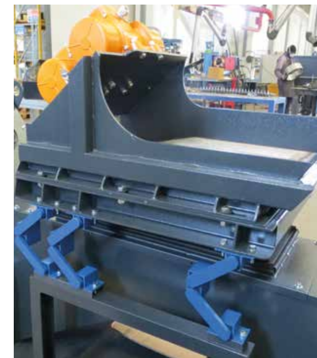
Setaccio applicato ad un trasportatore Sieve applied to a conveyor - Auf einem Förderer montiertes Netz
