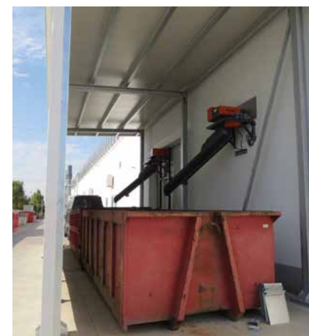
Scivoli per scarico truciolo su container Slides for discharge of chips onto containers Rutsche zum Abtransport von Spänen in einen Container
