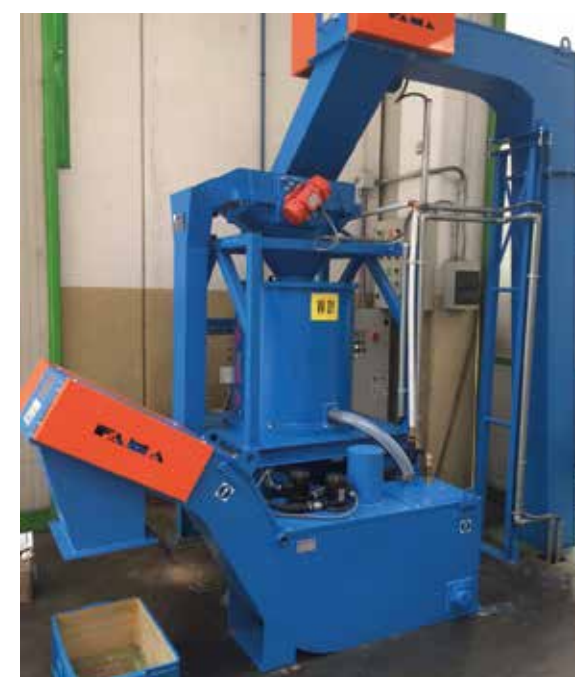
Vasca dragante a corredo di un gruppo di trattamento Dredging tank accompanying a treatment group Räumwanne an einer Vorrichtung zur Späneaufbereitung
