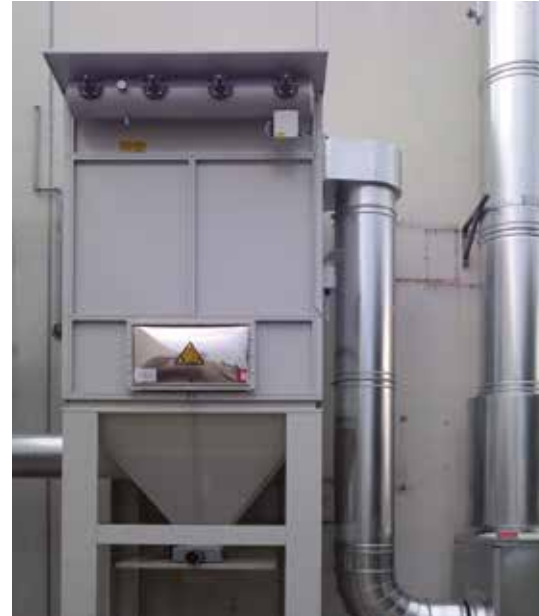
Filtro ATEX in categoria St2 con portello frontale St2 category ATEX filter with front door ATEX-Filter der Kategorie St2 mit Frontklappe
