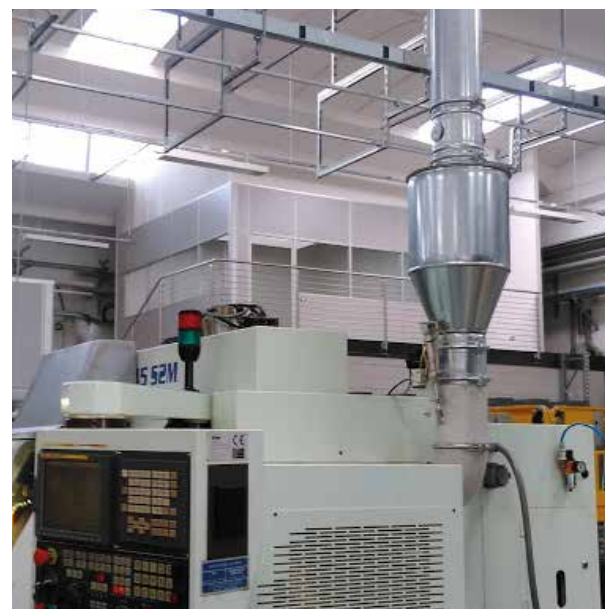
Pre-filtro a coalescenza Coalescence pre-filter Koaleszenz-Vorfilter
