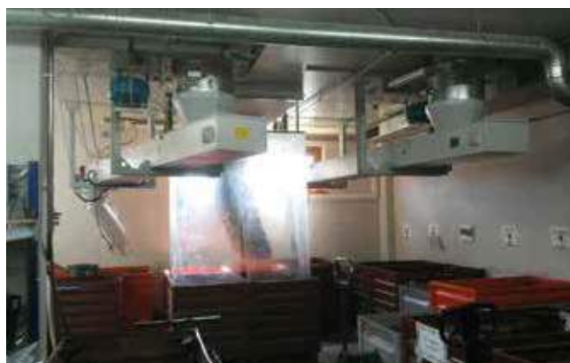
Trasportatori scarico truciolo con serranda tagliafuoco Chip discharge conveyors with fire damper Förderer zum Abtransport von Spänen mit Brandschutzklappe
